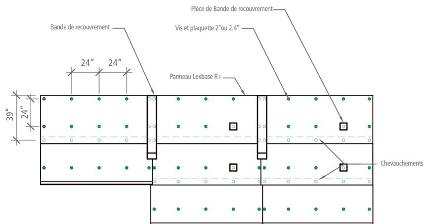
Les attaches mécaniques doivent pénétrer les pontages d'acier d'un minimum de  $\frac{3}{4}$ " , les pontages de bois de 1" et les pontages de contreplaqué de  $\frac{1}{2}$ ". Pour les pontages en acier, l'attache doit pénétrer le pontage dans la partie supérieure de la cannelure. (voir détail 3). Utilisez des plaquettes de 50 mm (2") ou 60 mm (2,4") dentelées en acier selon l'application. Les attaches doivent être placées à 1" minimum du bord du panneau afin de fournir un soutien adéquat.
